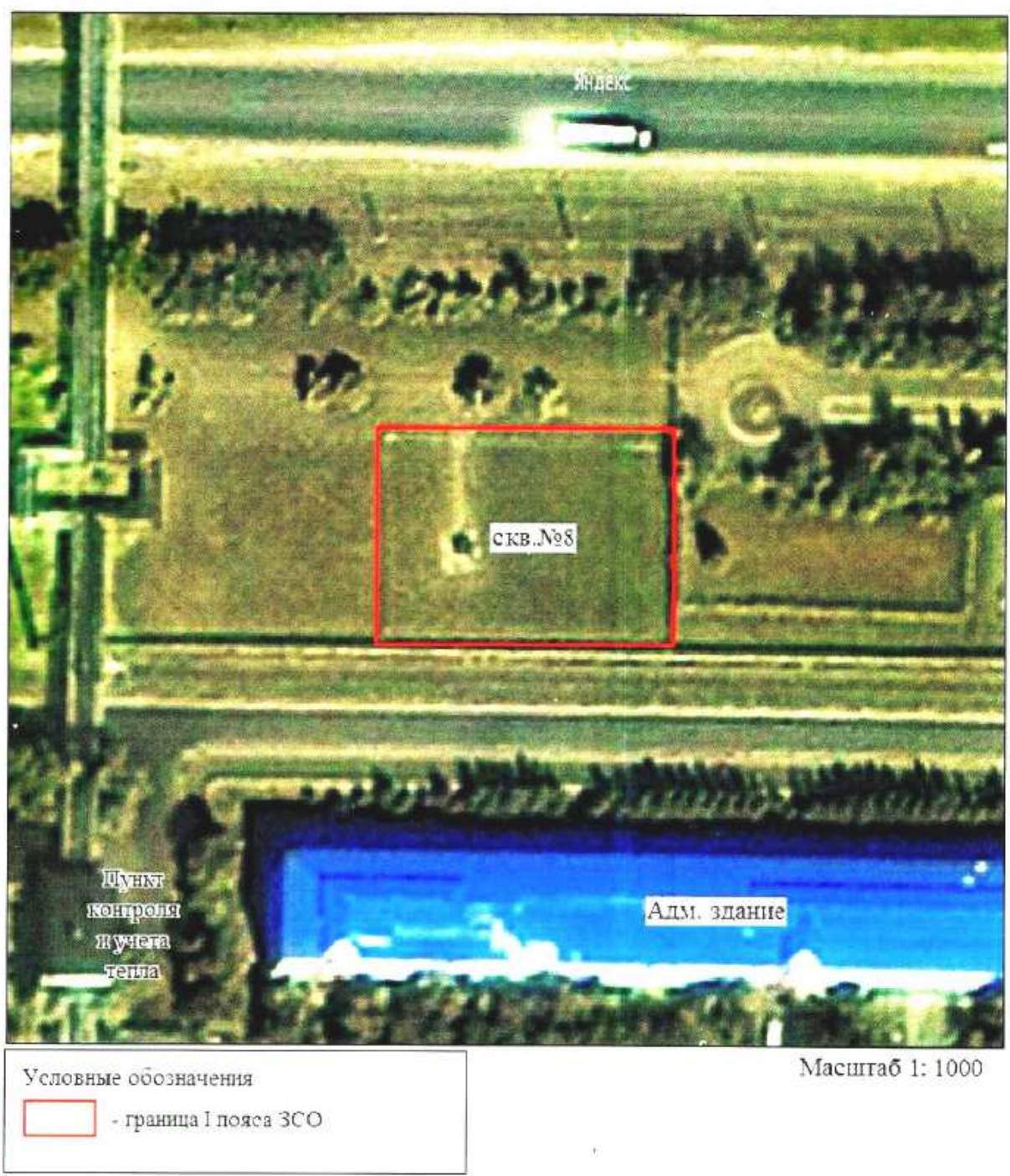
Рис. 3.1. План первого пояса ЗСО скважины №8 Масштаб 1:1000
